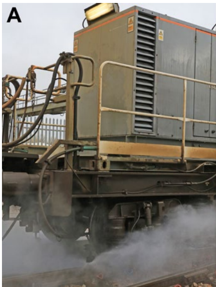
4: „Leaf Buster“ Spezialzug zur Entfernung des Blätter-Schmierfilms mithilfe eines Hochdruckwasserstrahls (A) und zum anschließenden Auftragen eines Gels aus Sand- und Stahlkörnern zur Erhöhung der Haftreibung (B)
