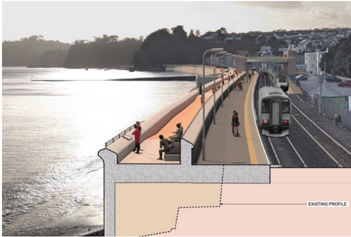
3: Geplante, verbesserte Ufermauer im Bahnhofsbereich von Dawlish zum Schutz der küstennahen Eisenbahninfrastruktur vor dem Meeresspiegelanstieg und extremen Sturmfluten
